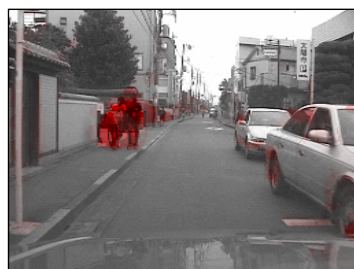
小型移動ロボットから撮影した動画像中の他のロボットの抽出例
